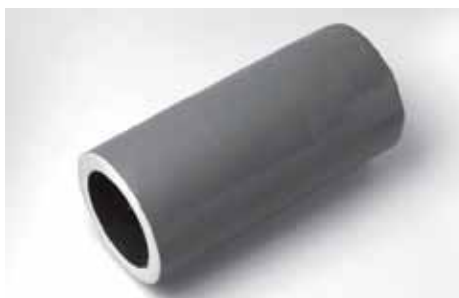
Isolerat rör MC46* med ljuddämpningsvärde 46 dB. Invändig diameter 100 mm, utvändig diameter 140 mm, längd 500 mm.
